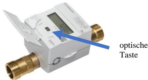
Nach Öffnung der Klappe wird zunächst eine Prüfung der Anzeige durchgeführt (d. h. alle Symbole auf der Anzeige werden kurz ein- und ausgeschaltet) und anschließend das Gesamtvolumen angezeigt. Dies wird mindestens 10 Sekunden lang auf der Anzeige angezeigt (auch wenn die optische Taste gedrückt wird). Anschließend kann mithilfe der optischen Taste die Anzeigeschleife gewählt werden. Durch Betätigen dieser Taste können nachfolgende Informationen abgerufen werden:
